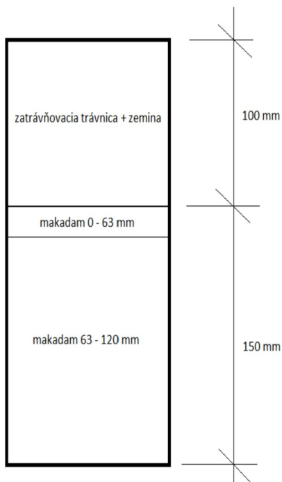
obr. VZOROVÝ PRIEČNY REZ SPEVNENOU PLOCHOU
